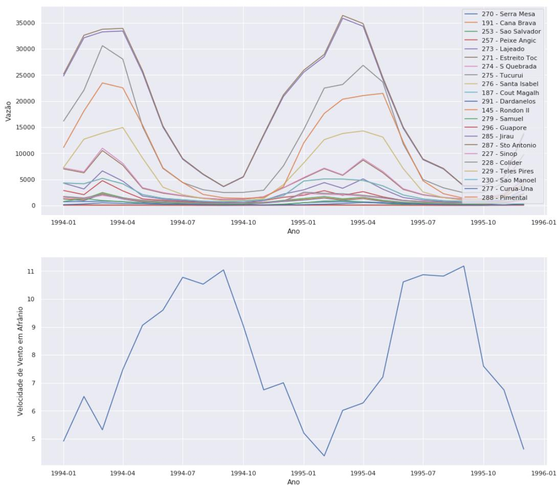
Figura 4.7: Comparação entre os valores dos 22 aproveitamentos hidrelétricos dos dados hidrológicos com a série temporal de velocidade de vento em Afrânio, no período de janeiro de 1994 a dezembro de 1995.
